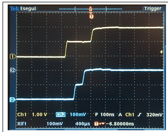
Fig. 14 Segnali all'estremo vicino (alto) e in un punto intermedio per una line aperta con driver adattato
